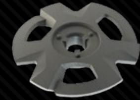
La rotella TOP, complementare al supporto TIP, è innovativa nella forma, nello scarico del materiale in eccesso ed è resa innovativa dalla modalità di smontaggio dal supporto: per inserirla, basta condurla alla fine della corsa delle guide predisposte nel supporto, fissandola con una rotazione in senso antiorario, mentre basterà piegare contemporaneamente i tre lembi verso il basso e ruotare la rotella in senso orario fino allo sblocco dalle guide del supporto TIP.
