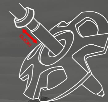
Für die korrekte Montage des Winter TIP-TOP Systems den Teller einfach auf der Spitze anbringen und Druck ausüben, bis die Einstellung im Sitz erfolgt (Klick!). Zum Abnehmen des Tellers umgekehrt vorgehen.
